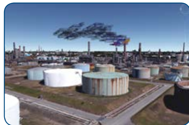
利用两台 SIGIS 2 系统同时测定气体云团, 并通过专用软件, 可得到这个烟囱周围的氨云 3D 化学成像 (结合谷歌地图可以看到氨气的浓度分布、飘散方向和浓度。浅色表示高浓度, 深色表示低浓度)
